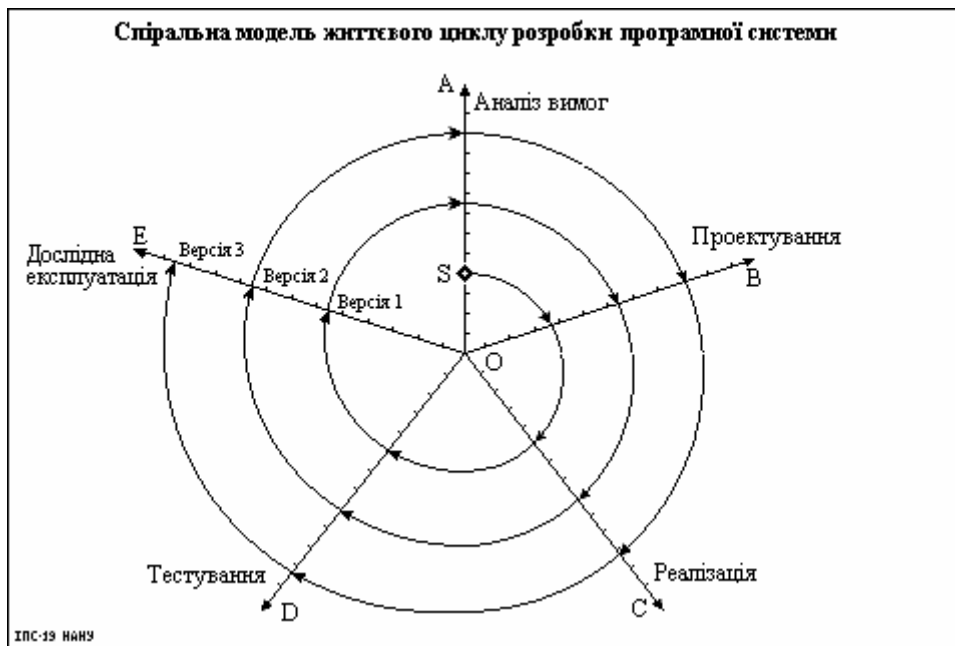
Рис. 1. Спиральна модель життєвого циклу програмної системи (режим розробки)
