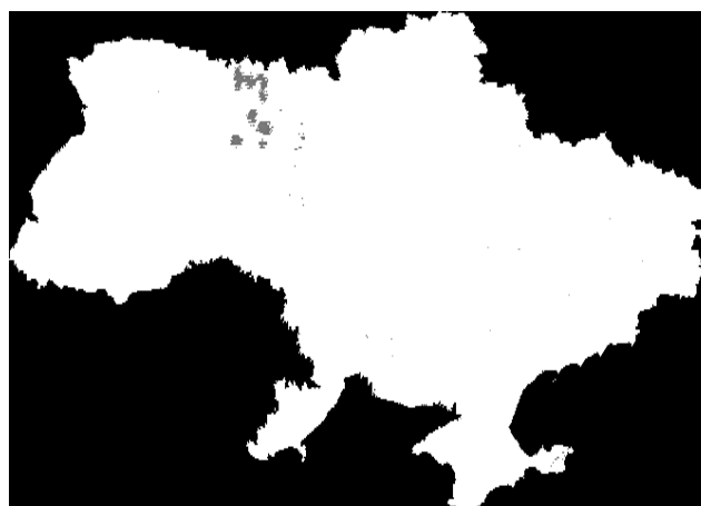
Рис. 2. Фрагмент супутникового знімку та результат фільтрації точок за маскою з ідентифікованою хмарністю
