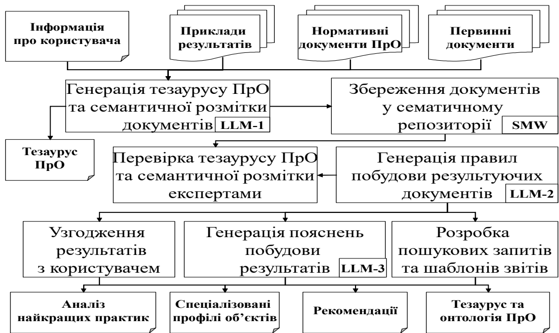
Рис. 2. Життєвий цикл інформації у технологічному середовищі “Лінза”
